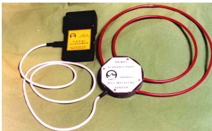
Figura 5-16 Sensor Virrib Basado en la Técnica de Transmisión de Fase
