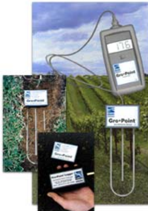
Figura 5-17 Sonda TDT Utilizada en la Medición del Contenido Volumétrico de Agua
