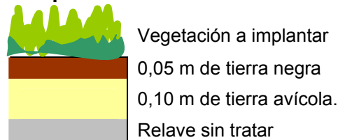
Figura 6-3 Perfil Final de la revegetación de la cobertura del Depósito de Relave de Milpo
