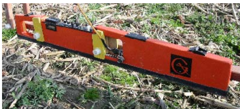
Figura 5-19 Equipo Portátil Tipo EM 38
