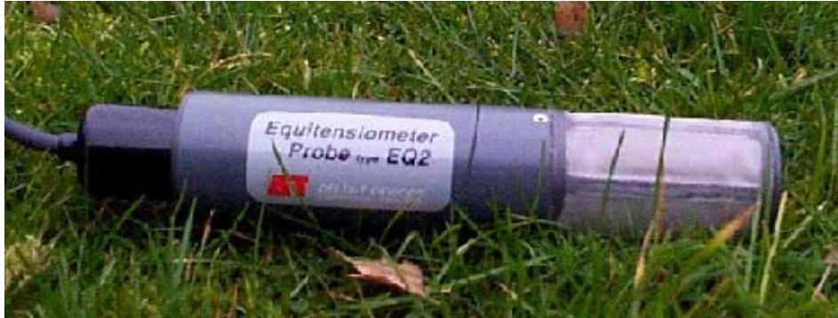
Figura 5-7 Sonda de Equipotenciómetro (Tipo EQ2)
