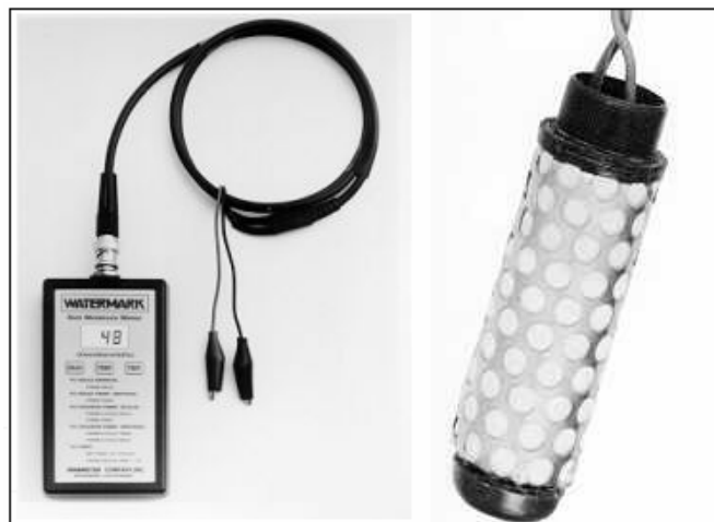
Figura 5-3 Sensor de Matriz Granular y su Medidor Digital (Tipo Watermark)
