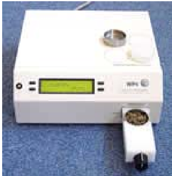
Figura 5-6 Potenciómetro WP4 de Precisión Milimétrica DW4
