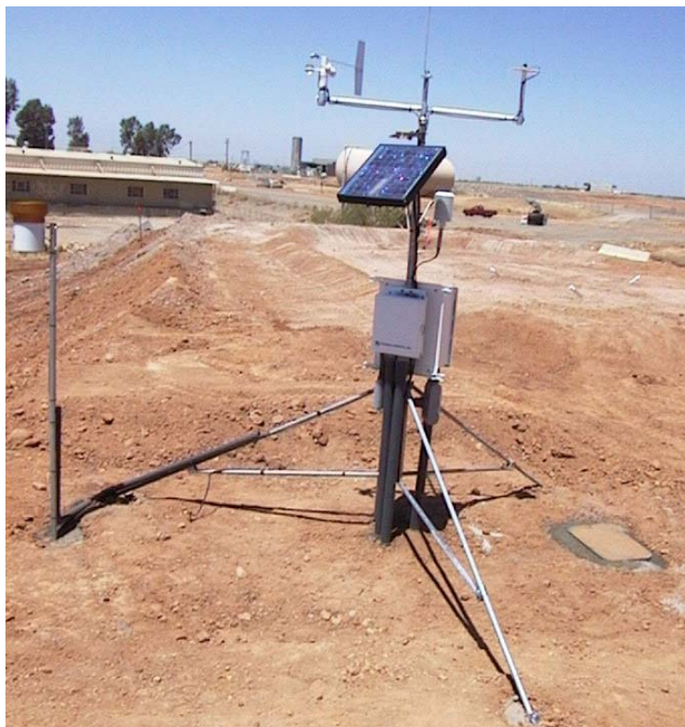
Figura 5-20 Estación Meteorológica Instalada en el Campo
