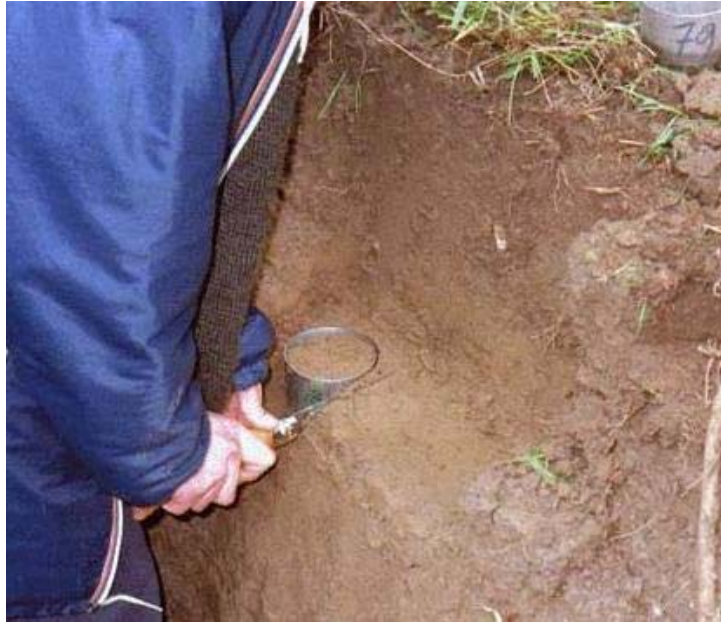
Figura 5-9 Muestreo del Suelo utilizando un Cilindro de Volumen Conocido
