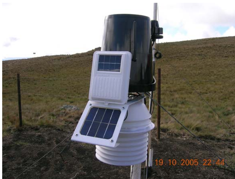
Foto 3-3 Estación Meteorológica Automática
