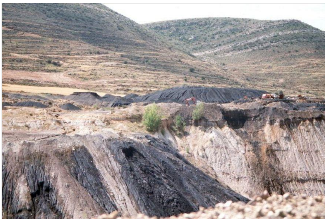
Figura 57. Escombreras de estériles diversos, procedentes de rocas blandas de la formación Escucha (arenitas, arcillas, carbón, etc.), con abundantes finos, sobre la ladera y en el hueco de la Corta Santa Lucía (Teruel) (verano de 2002), son ejemplos de materiales de baja durabilidad.
