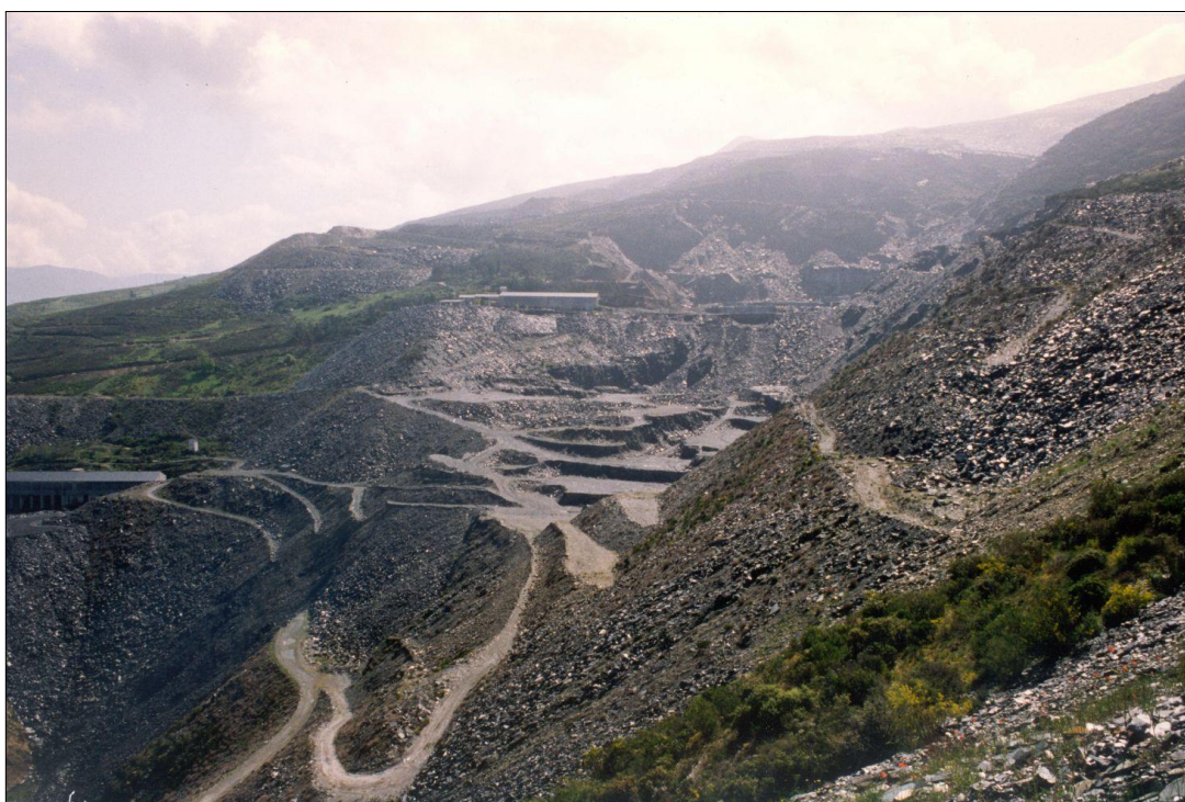
Figura 56. Escombreras de estériles de pizarra de techar en San Pedro de Trones (León). Ejemplo de materiales de alta durabilidad vertidos en vertientes de fuerte pendiente.
