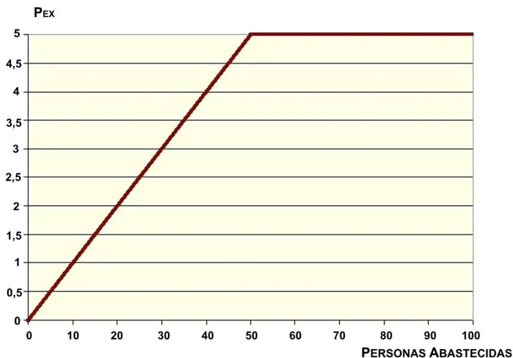
Figura 22. Gráfica que permite la asignación de valores del factor población expuesta ( P_{EX} ) en función del número de personas potencialmente abastecidas con aguas superficiales.
