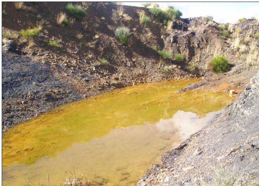
Fotografía 6. Formación de AMD y precipitados de hierro en corta de carbón
