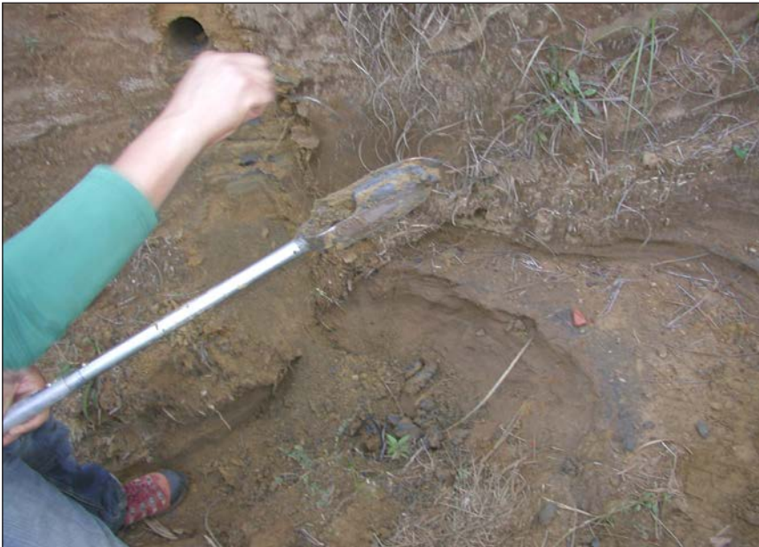
Fotografía 35. Toma de una muestra de lodos saturados con barrena de mano a una profundidad aproximada de un metro
