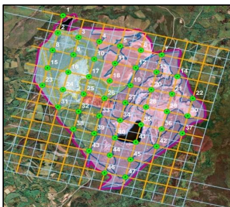
Figura 4.17. Selección de las Parcelas de estudio en la malla cuadrada de 200 x 200 m y su localización frente a los diferentes estratos de vegetación, delimitados mediante imagen de satélite.
