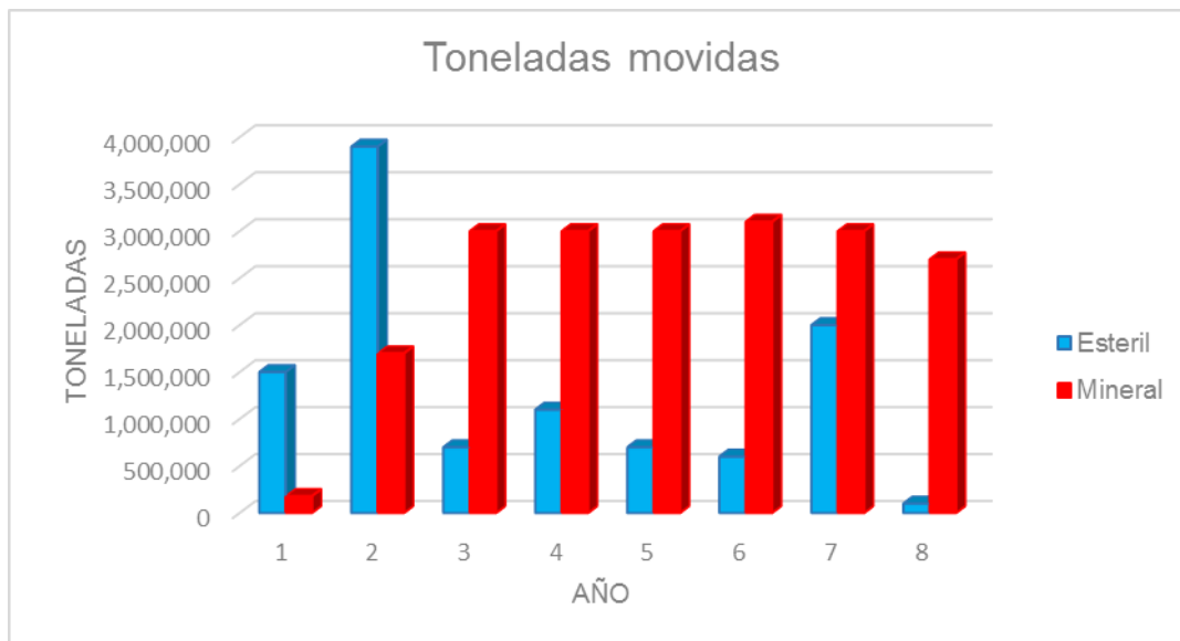
Figura 6.20. Planificación anual para 3Mt/año, movimiento de corta.
