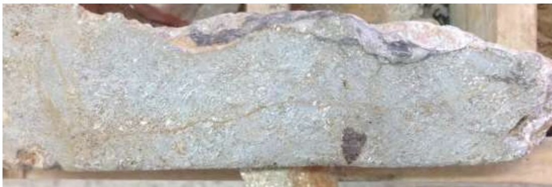
Figura 2.10. Ejemplo del greisen de la zona de cúpula, con mineralización de casiterita. Dimensión mayor en su lado N-S de 5,5 cm.
