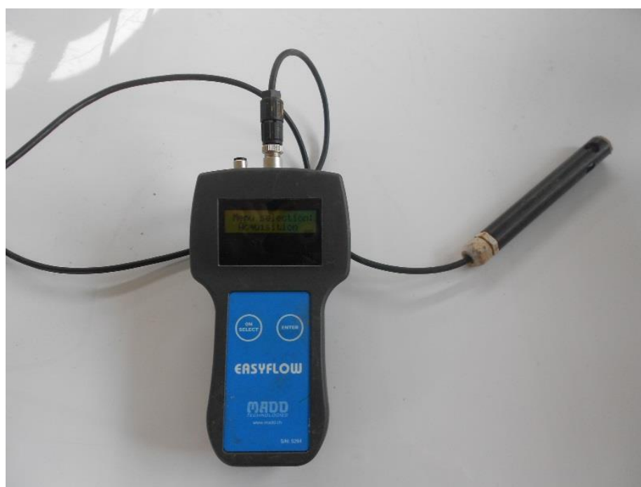
Figura 4.8. Equipo aforador químico.
