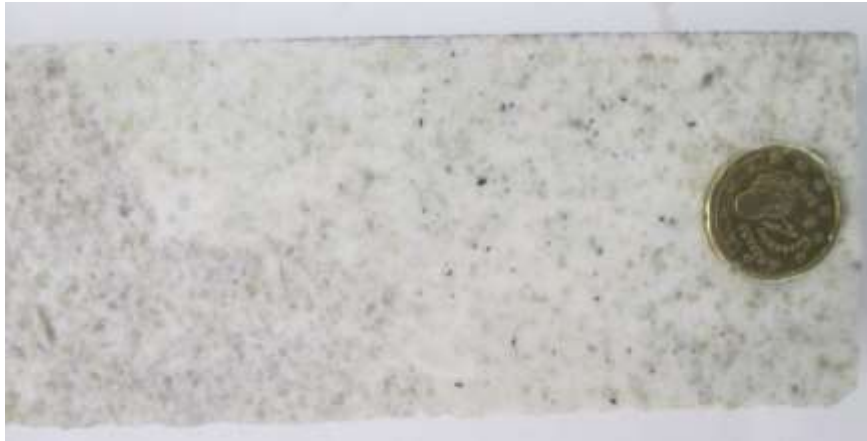
Figura 2.13. Ejemplo de mineralización diseminada de casiterita en el leucogranito albíico (punteado de color negro). La columbo-tantalita no es visible a simple vista, aunque sí con una lupa de mano.
