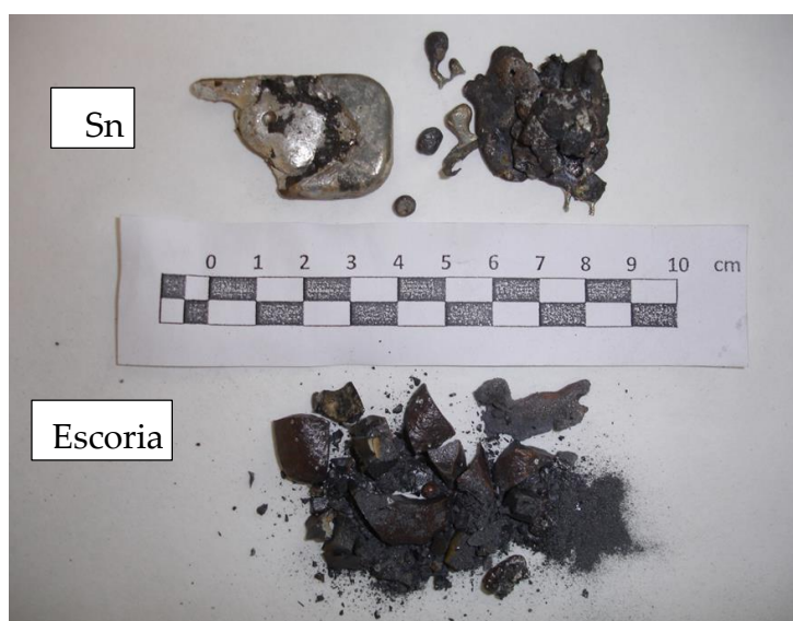
Figura 3.16. Estaño metálico y escoria obtenidos en un ensayo FAT.
