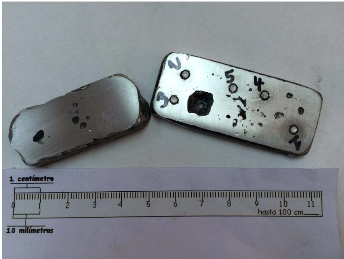
Fig. 5.3. Fotografía de Lingotes de estaño (98,5% en peso de Sn) obtenidos en el Centro Nacional de Investigaciones Metalúrgicas (CENIM) a partir de un concentrado mineral de la Mina de Penouta.
