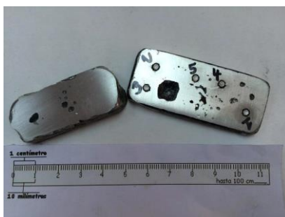
Figura 3.20. Lingotes de Sn obtenidos en el proceso de reducción en horno de gas.
