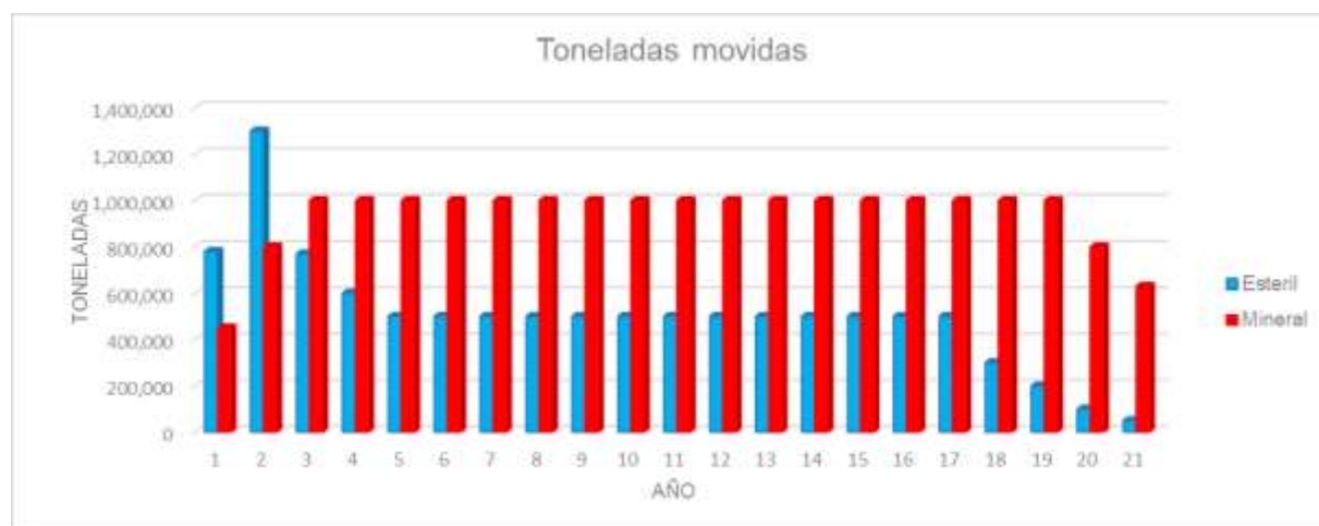
Figura 6.19. Planificación anual para 1 Mt de producción. Movimiento de la corta.
