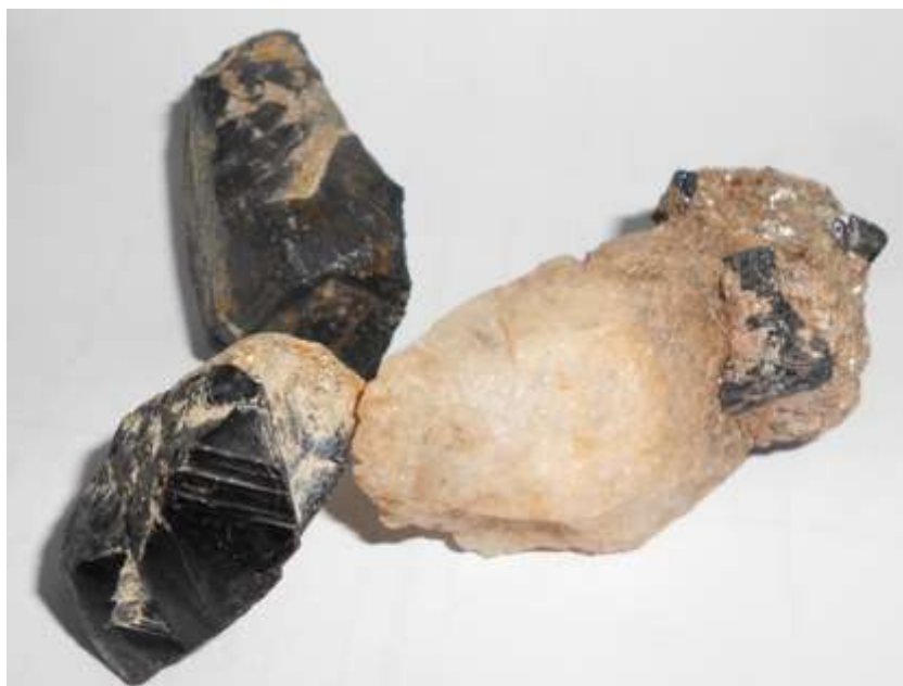
Figura 2.12. Ejemplo de cristales centimétricos de casiterita formados en el contacto del greisen con los filones de cuarzo.
