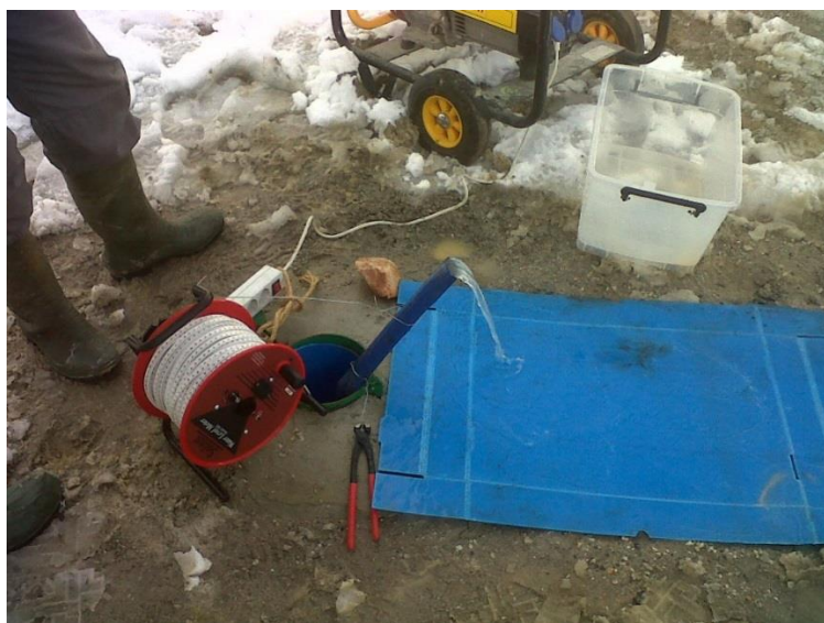
Figura 4.13. Ensayo de bombeo en un piezómetro.
