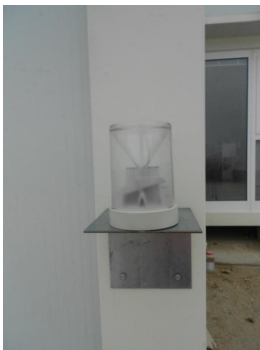
Figura 4.2. Instalación de un pluviómetro.
