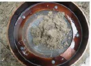
Malla 80 ASTM (0,177 mm) dispersión mecánica e hidromórfica / valores altos en respuesta a mineralización
