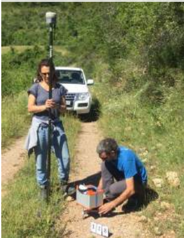
Medida con un gravímetro relativo y GNSS diferencial
