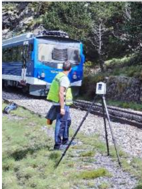
Generación de modelos 3D con láser escáner
