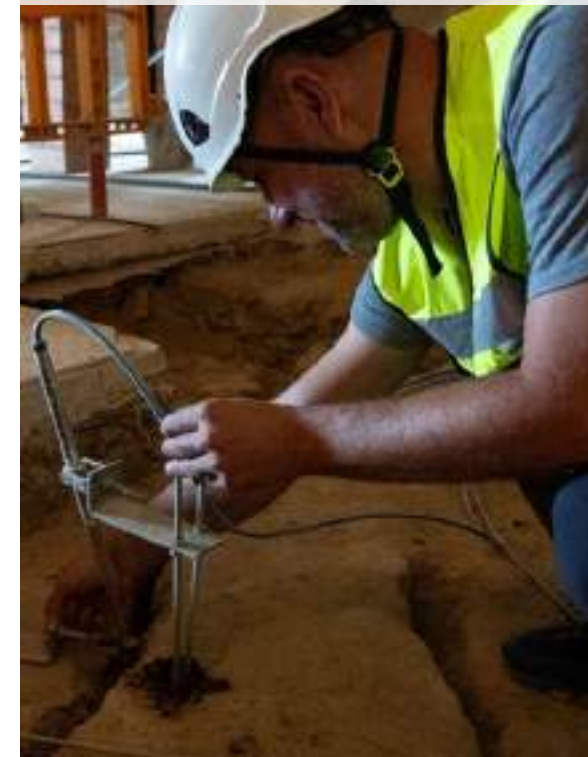
Auscultación de los movimientos del terreno con sensores de medida
