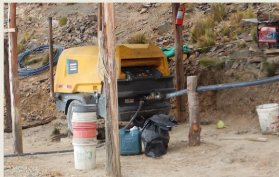
Las perforadoras neumáticas son accionadas con energía neumática desde unidades de generación de aire comprimido.
