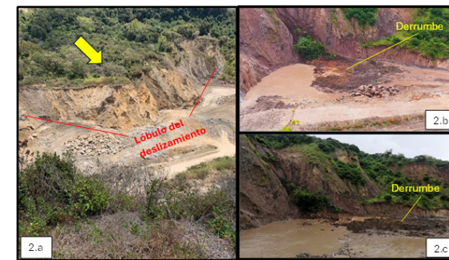
Figura 2. Registro fotográfico del cauce del río Reventado en el tramo del lóbulo del deslizamiento Banderillas. (2.a El deslizamiento se moviliza hacia el cauce del río Reventado. El lóbulo forma un escarpe de 5 metros de altura que requiere ser terraceado. 2.b Los derrumbes desde este escarpe obstruye el cauce del río Reventado. 2.c Los derrumbes crean represamientos del flujo activo del cauce.
