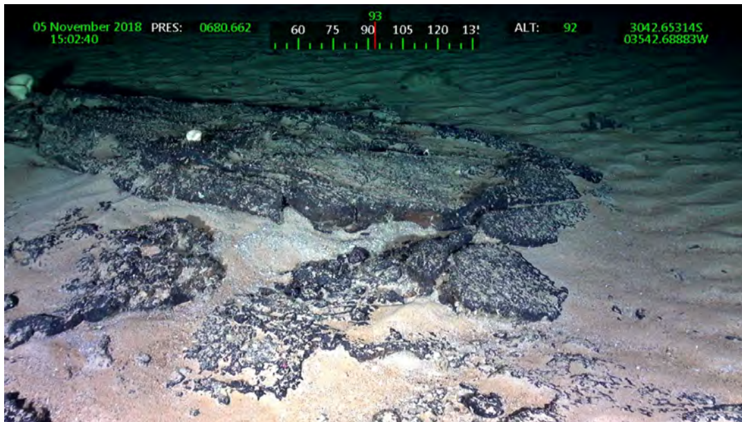
Figura 5. Imagen de costras de ferromanganeso ricas en cobalto obtenida con el robot submarino “Hybis” en la Elevação de Río Grande. Fuente: Universidad de São Paulo (Brasil)
